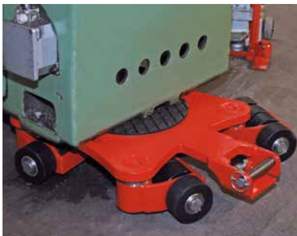
Kreiselfahrwerk JKB im Einsatz
