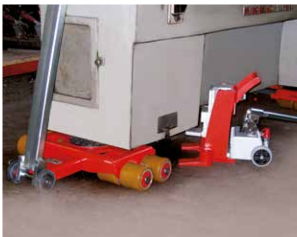
Kugelgelagerte Rollen garantieren einen leichten Lauf.
