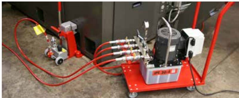
Elektropumpe JPE 30 NVR mit 2 Hebeegeräten im Einsatz
